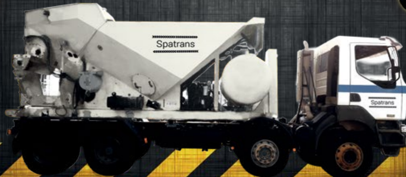
PLATA MÓVIL DE CONCRETO
